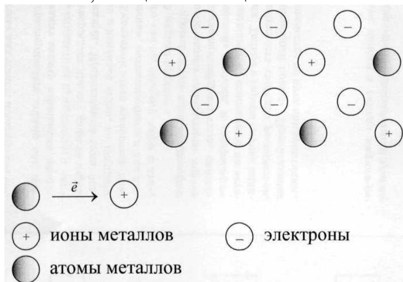
Рис. 18. Схема образования металлической связи
